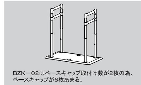
❗ ・使用しない支柱取付け穴には必ずベースキャップをはめる。
