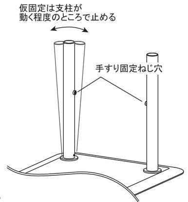
2. 手すりを支柱に差込み、手すり高さのガイド線を確認しながら手すり高さを決める。手すり固定ねじを手回して2回転ほど仮固定した後に、六角棒スパナ(呼び4mm)で奥まで締付ける。
